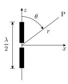
É alimentada na junção dos dois fios (origem) por uma tensão sinusoidal de frequência  $\omega$ . A corrente resultante nos fios pode ser bem aproximada por
