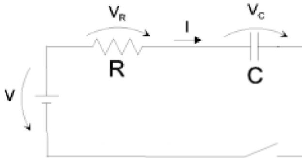
Figura 2: Circuito RC - Carga
