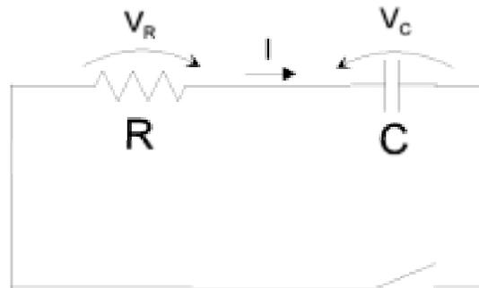
Figura 4: Circuito RC - Descarga
