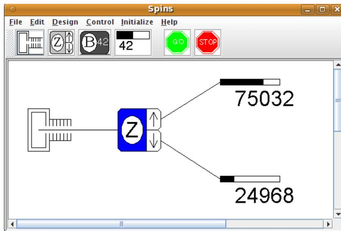
onde os números nos contadores indicam o número de electrões detectados depois de terem sido *disparados* 100000 electrões num dado estado e após terem passado por um analisador de spin segundo o eixo dos  $z$ . Então o estado inicial pode ser representado por
